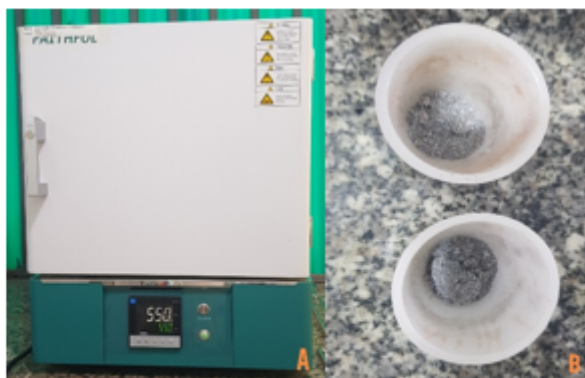
Figura 15- (A) Amostra na mufla (B) Cinzas
