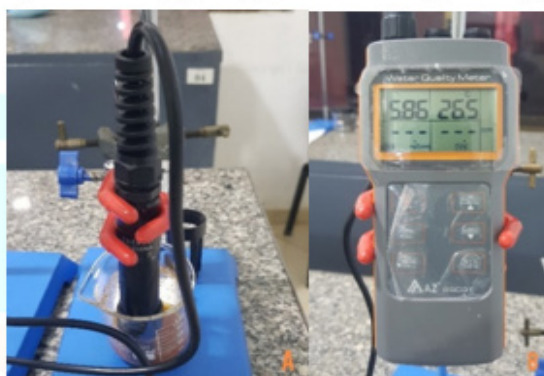
Figura 14- (A) e (B) Determinação de pH
