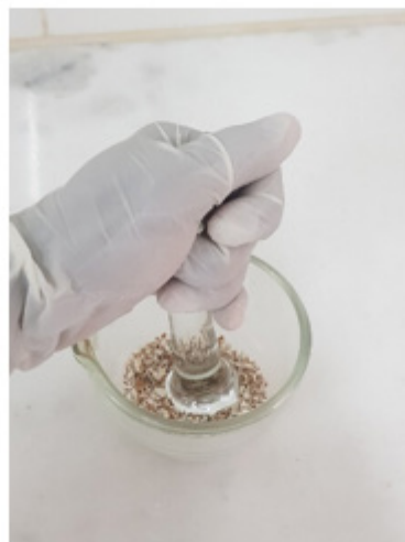
Figura 20- Trituração das cascas de ovos
