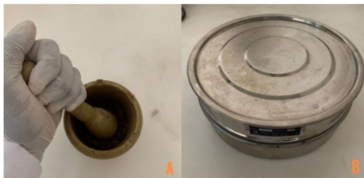
Figura 11- (A) Trituração e (B) Peneiração
