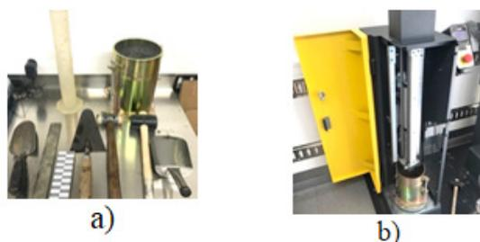
Figura 13- Compactação proctor; a) Utensílios de laboratório, b) Compactador dinâmico
