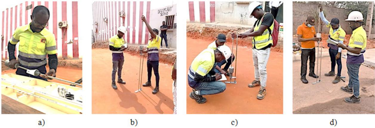
Figura 18- Ensaios de campo com DCP; a) montagem do equipamento, b) posicionamento, c) Registo da Leitura na camada de sub-base, d) registo de leitura na camada de base
