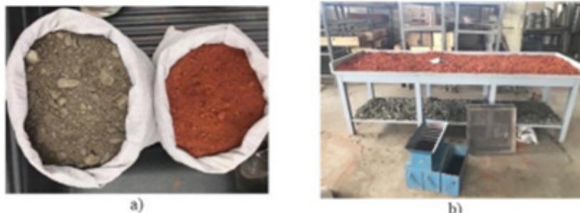
Figura 6-Amostragem; a) Amostras recolhidas; b) Secagem ao ar livre, esquadrelador e malhas  $\frac{3}{4}$  e 4
